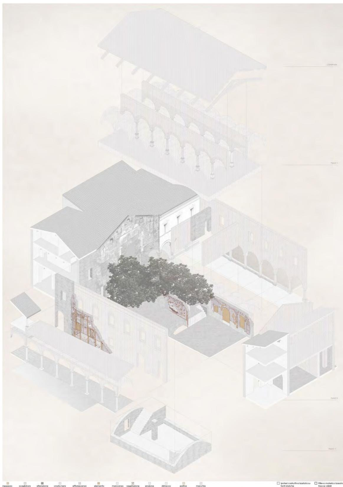
Fig. 2. Esploso assometrico dello stato attuale del complesso con mappatura dei fenomeni di degrado rilevati e ipotesi di configurazione degli elementi architettonici mancanti.
