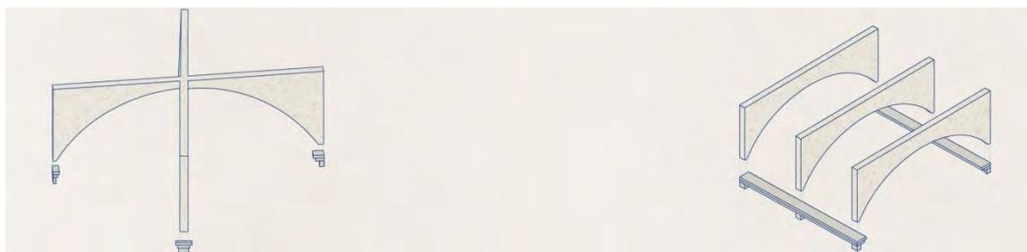
Fig. 4. Integrazione delle volte mancanti attraverso la posa in opera di nuovi elementi in agglomerato di calcestruzzo armato con aggregati di Pietra di Vicenza color avorio accuratamente selezionati. La realizzazione avviene attraverso l'uso di casseforme su misura.
