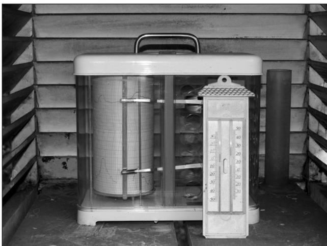
Fig. 2 - Termoigrografo 1750/3 e termometro min/max di controllo
