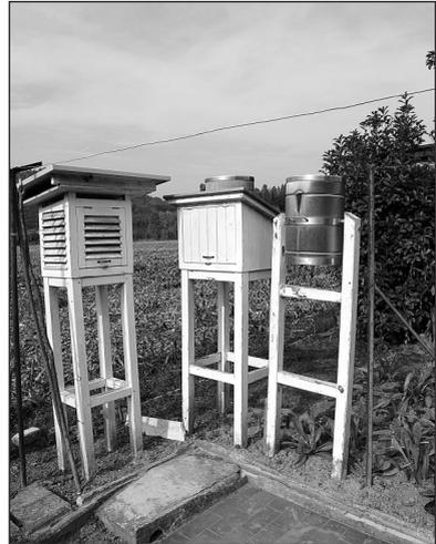
Al fine di disporre di misure termometriche corrette nelle serie di dati delle stazioni dei Berici, i termoigrografi sono stati costantemente controllati e periodicamente inviati alla ditta costruttrice per interventi di controllo, revisione e taratura.
