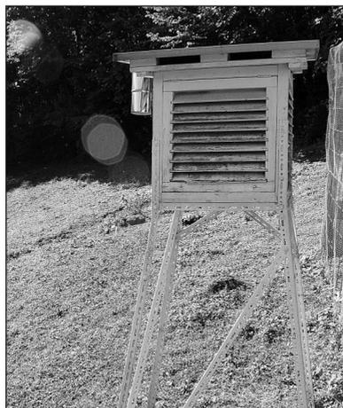
**Nanto Monte della Torretta** - capannina del termoigrografo e pluviometro Hellmann
